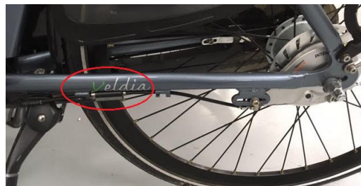
Foto 5.2: Rollerbrake of schijfrem achter
